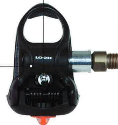
Vu de dessous, on distingue nettement le renfort "Infini Design" en forme de "B" couché.
