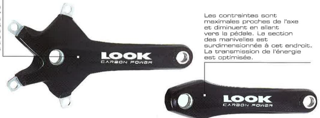
Les contraintes sont maximales proches de l'axe et diminuent en allant vers la pédale. La section des manivelles est surdimensionnée à cet endroit. La transmission de l'énergie est optimisée.
