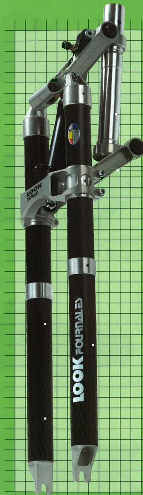
Amortisseur oléopneumatique. Confort et progressivité en utilisation intense. Réglage de la détente par vis de refolement. Réglage de la compression par admission d'air dans l'amortisseur.
